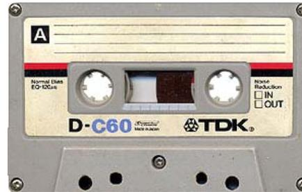
Il nastro di una Compact Cassette da 60' ha uno spessore  $h$  di circa  $15 \mu\text{m}$ . Esso può essere trovato indirettamente misurando come varia la parte di nastro avvolta  $r$  nel tempo. Supponiamo di far partire il registratore all'istante  $t=0$  quando  $r=r_0$ . Nel tempo  $\Delta t$  la bobina sarà ruotata di un angolo  $\Delta\theta$  corrispondente a un numero di giri  $\Delta n$  tale che
