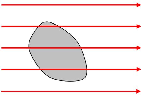
$\vec{E}_{est}$  agisce sulle cariche libere  $\pm q$  del conduttore ponendole inizialmente in moto.
