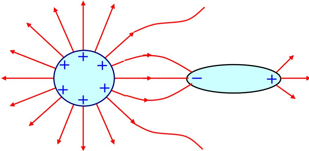
Per il principio di sovrapposizione, assumendo che la distribuzione della carica sulla sfera non sia modificata sensibilmente, il potenziale della sfera non isolata  $V_{s.n.i}$  è:
