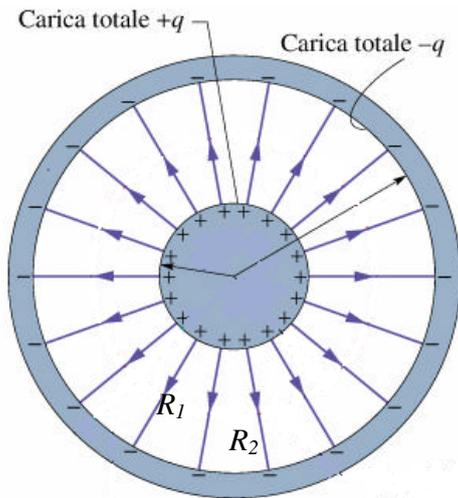
Ricordiamo che il campo è diverso da zero solo nei punti a distanza dal centro  $R_1 \leq r \leq R_2$  ed è pari a:
