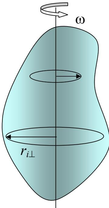
Consideriamo una generica particella  $m_i$  del corpo rigido a distanza  $r_{i\perp}$  dall'asse di rotazione. Detta  $\omega$  la velocità angolare di rotazione del corpo rigido intorno all'asse, la particella  $m_i$  ha una velocità lineare:
