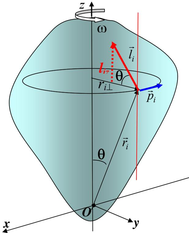
Consideriamo una generica particella  $m_i$  del corpo rigido a distanza  $\vec{r}_i$  da un punto di riferimento  $O$ , posto sull'asse di rotazione. Detta  $\omega$  la velocità angolare di rotazione del corpo rigido, la particella  $m_i$  ha una quantità di moto  $\vec{p}_i = m_i \vec{v}_i$  ed un momento della quantità di moto  $\vec{l}_i = \vec{r}_i \times \vec{p}_i$ .
