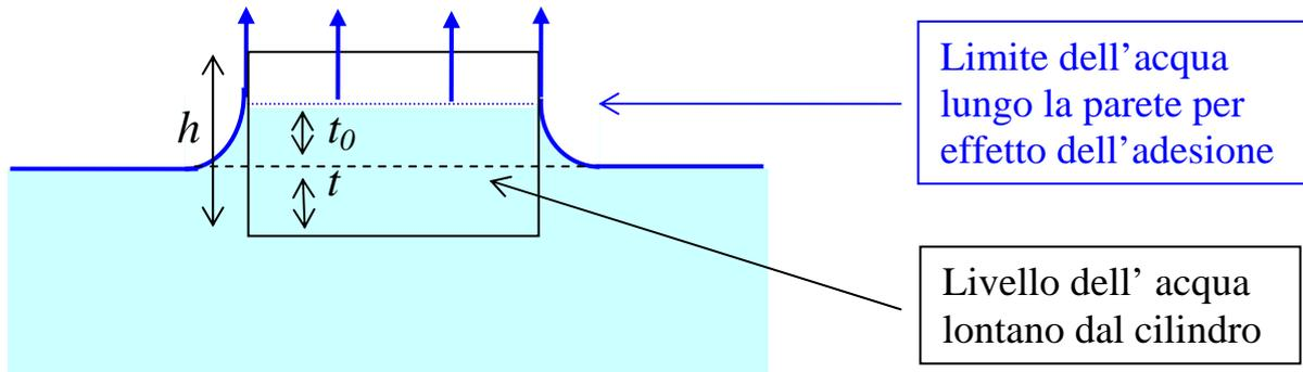
Le forze di adesioni che causano l'innalzamento del fluido sono calcolabili, osservato che  $\cos\phi = 1$  da  $\tau_v = \tau \Rightarrow F_{v,tot} = \tau \cdot L$  con  $L = 2\pi r \Rightarrow F_{v,tot} = \tau 2\pi r$
