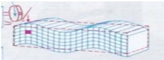
Onda trasversale in una barretta sollecitata trasversalmente
