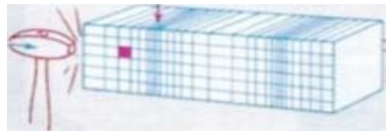
Onda longitudinale in una barretta sollecitata longitudinalmente
