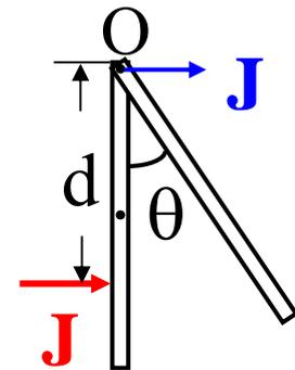
l' asta, per compiere un giro completo, deve ruotare di  $180^\circ$ , giungendo nel punto più alto con  $\omega_F \geq 0$
