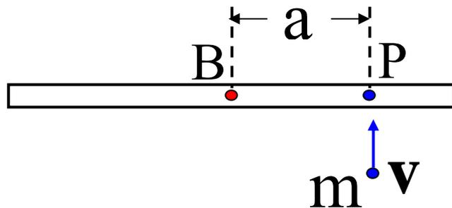
1) moto dopo l'urto: traslazione di CM + rotazione attorno ad un asse passante per CM del sistema dopo l'urto
