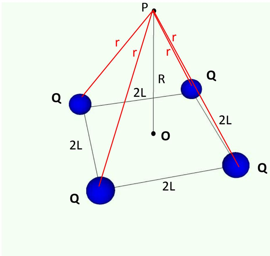
Il problema presenta una geometria 3D abbastanza complessa. Come possiamo ricondurlo ad una geometria bidimensionale? Poiché possiamo avvalerci del principio di sovrapposizione, possiamo considerare il contributo di due cariche nel punto  $P$ , poi quello delle altre due e sommare i due contributi che otterremo. Questa semplificazione ci consente di considerare il piano passante per il punto  $P$  e per due cariche  $Q$  diametralmente opposte:
