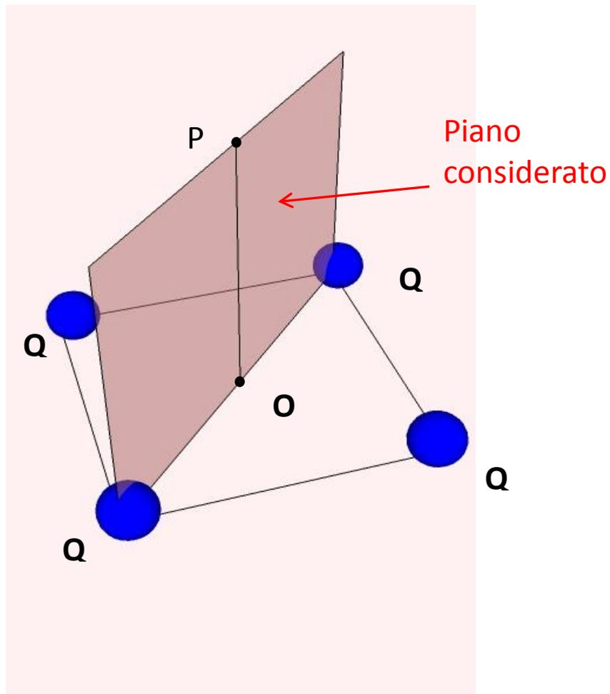
Nel piano considerato in figura, indico con  $\vec{E}_1$  il campo elettrico generato dalla carica  $Q_1$  nel punto P e con  $\vec{E}_2$  il campo elettrico generato dalla carica  $Q_2$  nel medesimo punto P. Non si può prescindere dalla natura vettoriale del problema, in quanto, come discende dalla definizione della forza di Coulomb sappiamo che la direzione della forza è diretta lungo la congiungente delle due cariche:
