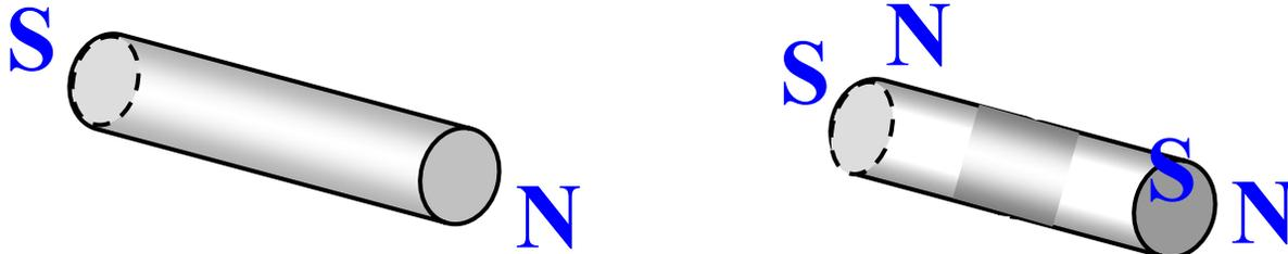
Elemento costitutivo dei magneti: dipolo magnetico elementare, caratterizzato da un momento di dipolo magnetico  $\mathbf{m}$
