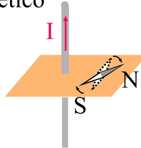
La deviazione di un ago magnetico avvicinato ad una corrente indica che **una corrente elettrica è sorgente di un campo magnetico**
