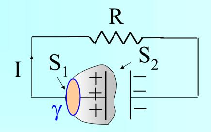
Le linee di corrente partono dall' armatura positiva e terminano sull' armatura negativa:
